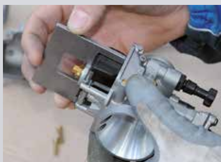
Float level check - Controllo livello galleggiante
